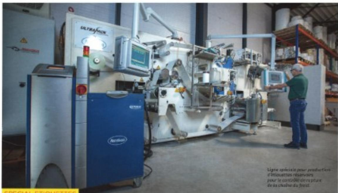
Ligne spéciale pour production d'étiquettes réservées pour le contrôle de rigueur de la chaîne du froid.
